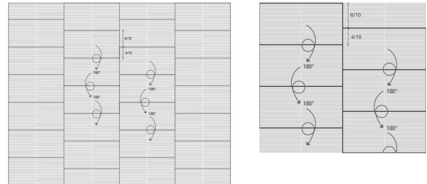
Pour ce format de tuile murale, faire l'installation de la tuile à l'aide du mortier-colle **Litefix** ou **Flex GT-30**. Utiliser une truelle 1/4"x3/8" ou 1/2"x1/2". Avec le côté plat de la truelle, appliquer en exerçant une pression, une mince couche de mortier puis appliquer de nouveau une couche avec le côté dentelé de la truelle. Toujours apposer du mortier-colle derrière la tuile avec le côté plat de la truelle pour ainsi poser à double encollage.
